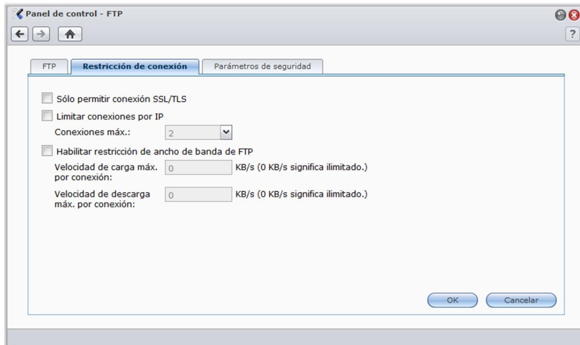
Para configurar la restricción de conexión FTP, marque cualquiera de las siguientes opciones y haga clic en **OK**:
