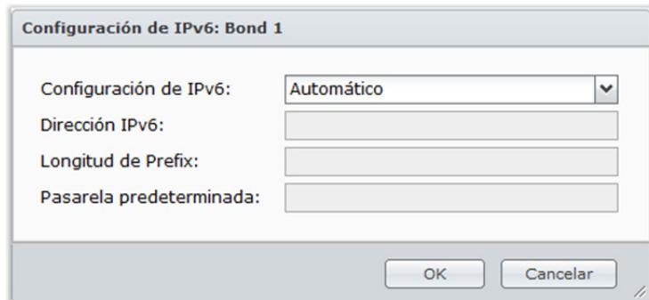
Synology DiskStation admite el esquema de pila dual IPv4/IPv6. Esto significa que tanto IPv4 como IPv6 pueden trabajar simultáneamente en Synology DiskStation. La configuración predeterminada para IPv6 es **Automático**.<sup>1</sup>
