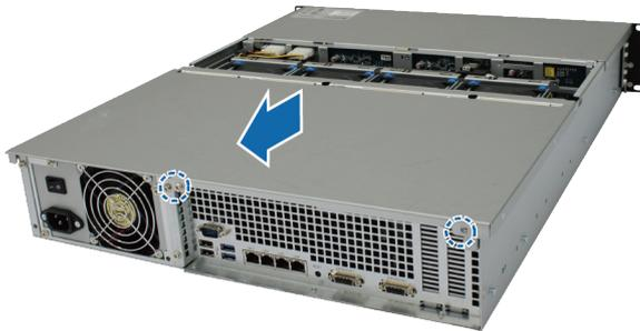
c 鬆開固定支撐架的螺絲，並取出支撐架，以露出記憶體插槽。
