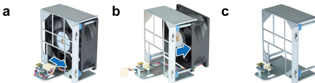
6 將新的風扇推入風扇殼中，將電源線接上電源埠。
