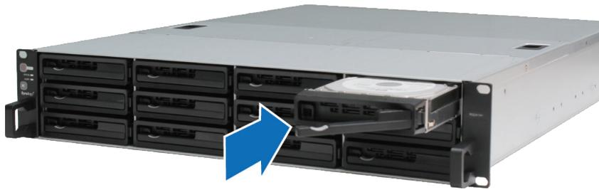
**重要事項：**請確定已將托盤完全推入，否則硬碟可能無法正確運作。
