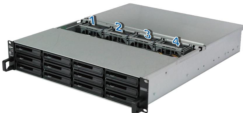
4 找出故障的風扇，將風扇拉出並移除。
