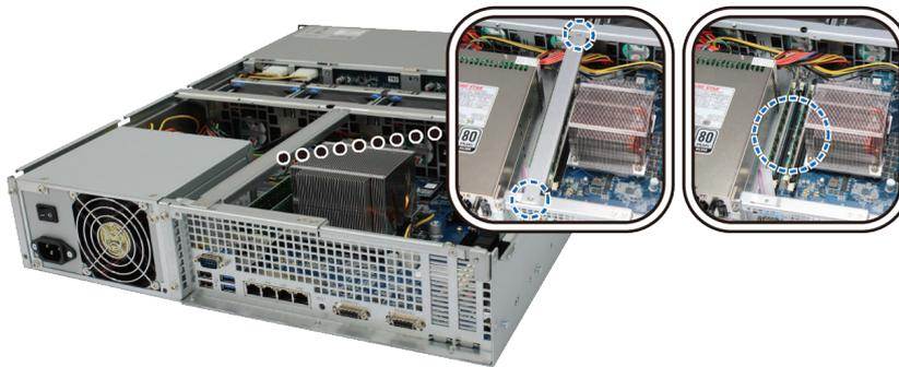
**重要事項：**取下護蓋後將暴露出內部脆弱的零件。在新增或移除記憶體時，請避免觸摸任何零件，以免造成損害。
