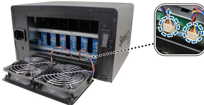
c Entfernen Sie die Schrauben, die den Lüfter fixieren, vom Gehäuse.
