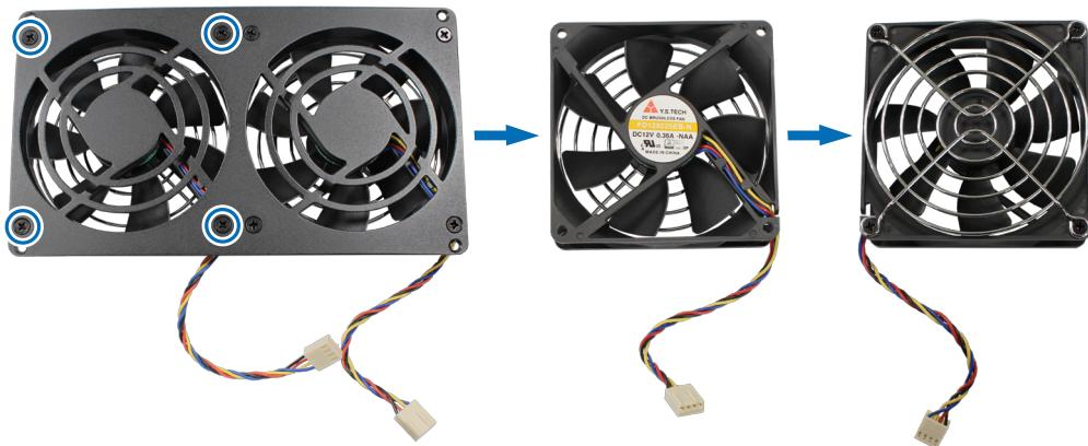
d Entfernen Sie die Schrauben, mit denen das Gitter am defekten Lüfter befestigt ist.
