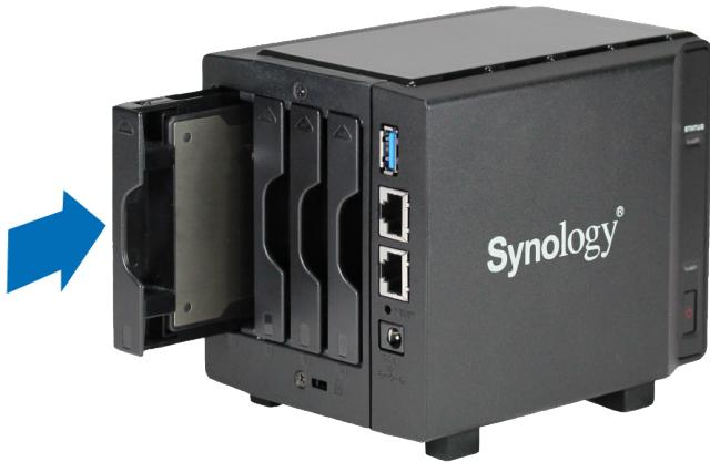
**Wichtig:** Stellen Sie sicher, dass der Festplatteneinschub vollständig eingeschoben ist. Ansonsten läuft die Festplatte möglicherweise nicht ordnungsgemäß.
