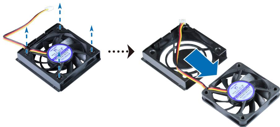
5 Schieben Sie einen neuen Lüfter in das Gehäuse. Ziehen Sie die Schrauben fest, um den Lüfter zu fixieren.
