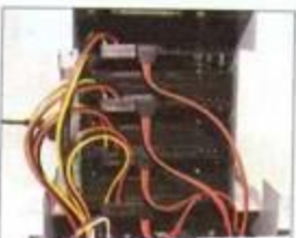
專用線材連長度也作出調整，令線材不會妨礙氣流移動。
