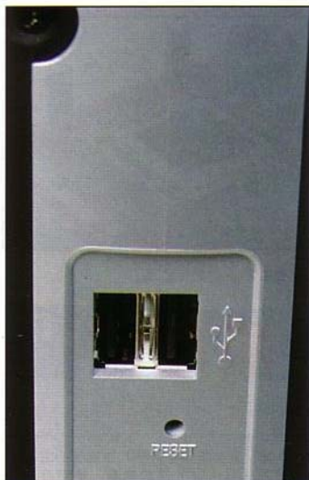
后面有2个USB埠, 可连接USB磁碟扩大储存空间。
